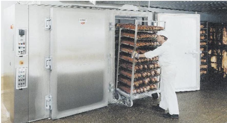
Abb. 10: Der Schrankfroster ist für das chargenweise An- und Tiefgefrieren bei hohen Gefrierleistungen geeignet
